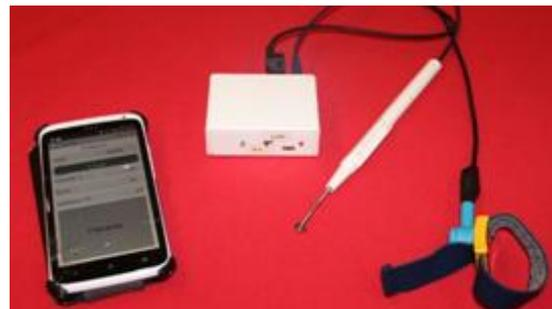
*Fig 1 : L'électrogustomètre est un générateur de courant constant à pile sans aucune liaison avec le secteur. Le courant délivré ne peut pas dépasser 200µA.*
